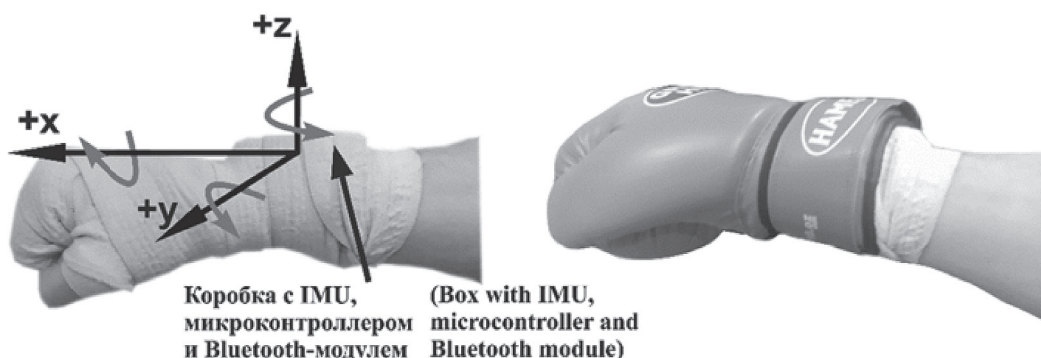
Рисунок 3 – Измерительный модуль, закрепленный на руке при помощи боксерского бинта, и боксерская перчатка вместе с измерительным модулем
